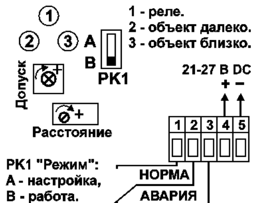
Рис. 7. Схема подключения, органы регулировки и индикации датчика.
